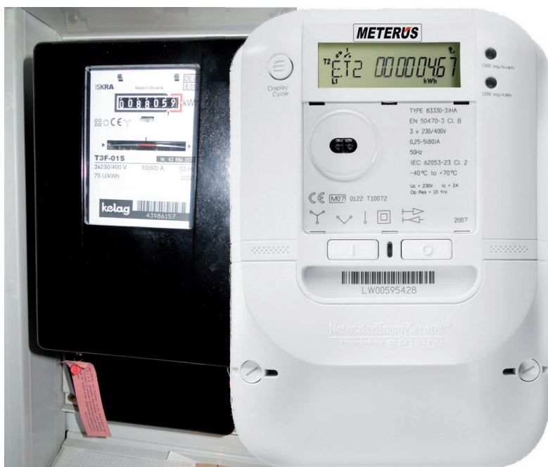
Abb. 1 & 2 Ferraris - Zähler (links) und Smartmeter (rechts)
